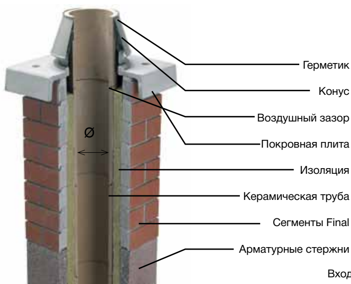
Комплект UNI Final для верхней части дымовой трубы
